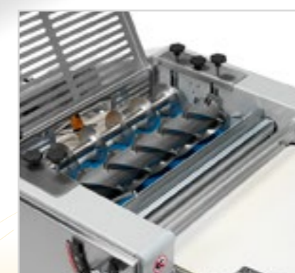
La stazione di taglio a due principi evita che la pasta si attacchi allo stampo. The double seat cutting station avoids the dough to stick in the moulds.
